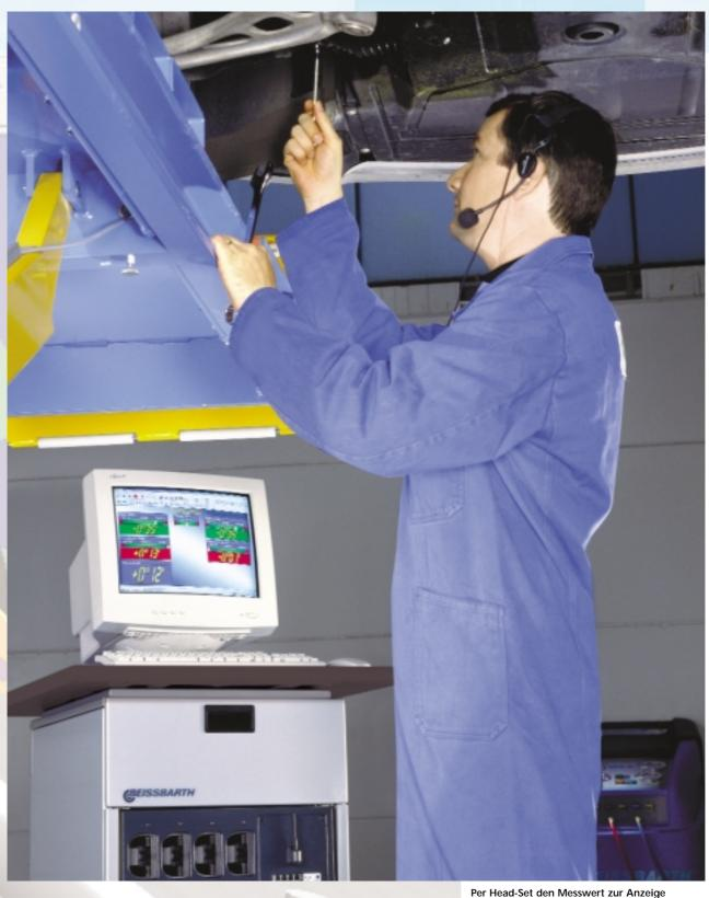
Per Head-Set den Messwert zur Anzeige bringen. So bleiben beide Hände frei für die Fahrwerkseinstellung.
